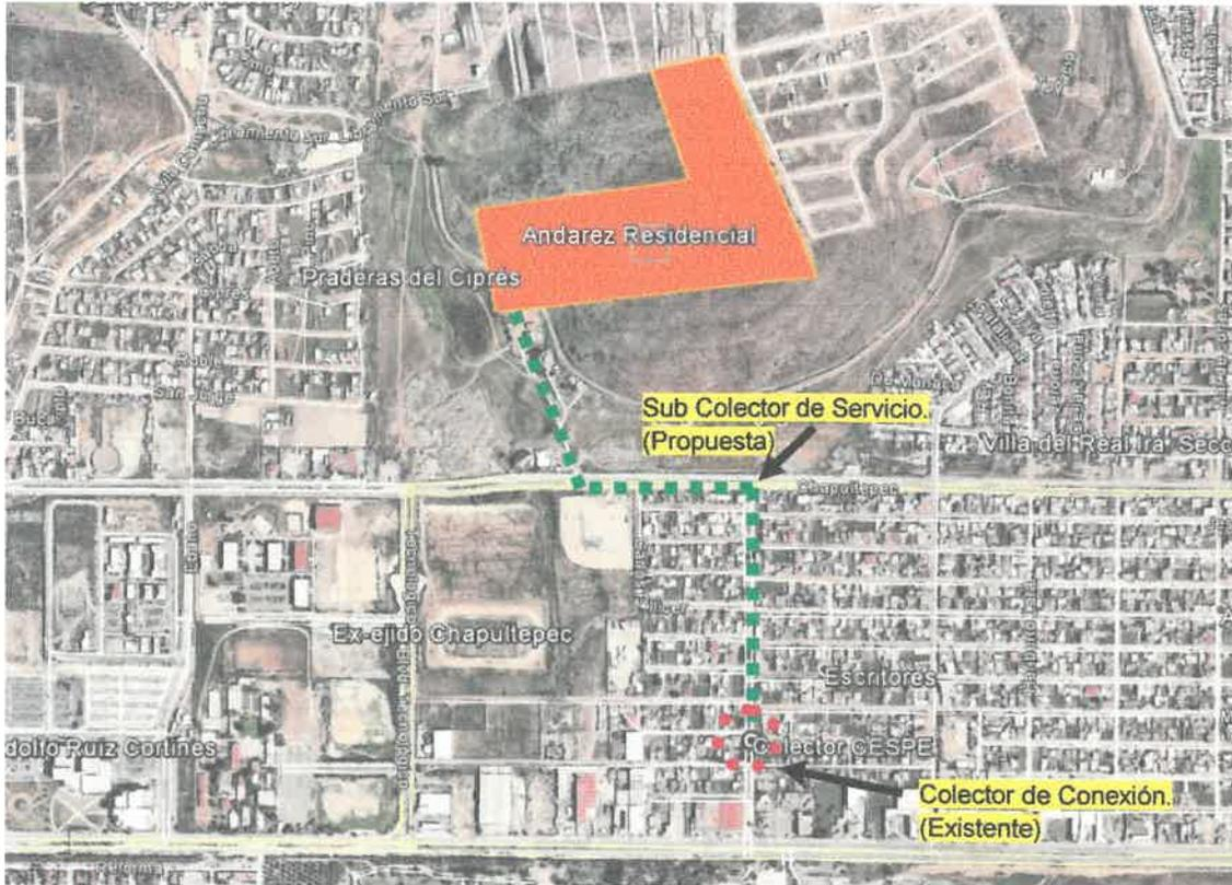
Imagen 20. Proyección de Conexión de Alcantarillado Sanitario.
